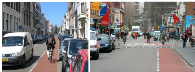
Контр-смуги у вигляді велосипедних смуг руху на вузьких та широких вулицях з одностороннім рухом (зображення: D. Dufour, P. Kroeze)
